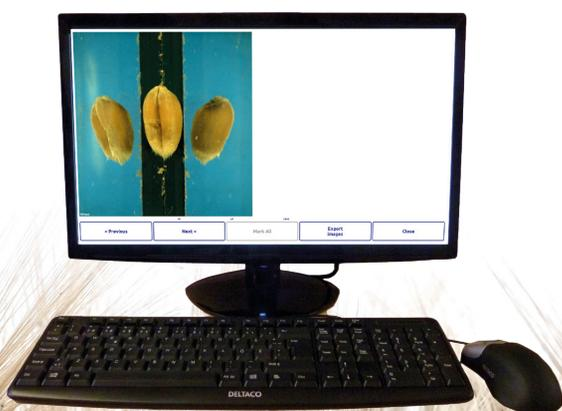
La conception unique et brevetée du miroir visualise chaque grain sous trois angles, permettant l'inspection de presque toute la surface du grain à l'aide d'une analyse d'image avancée.
