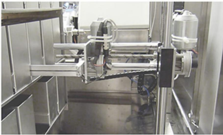
**SEEDSCANNER** ist mit einem Roboter ausgestattet, der für die Handhabung der Probenschubladen verantwortlich ist. Dabei wird sichergestellt, dass die Proben keinen Schaden nehmen können oder Saatgut verändert wird.
